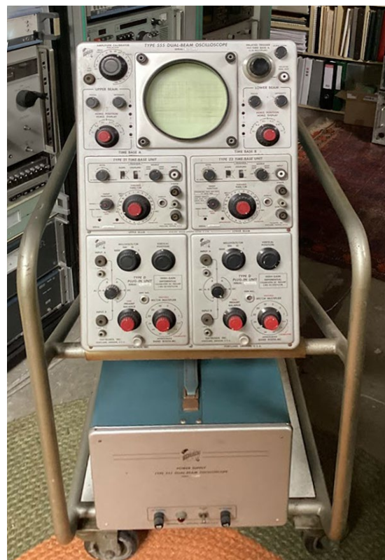
Figuur 2-37: De Tektronix 555 met aparte voedingsunit.
