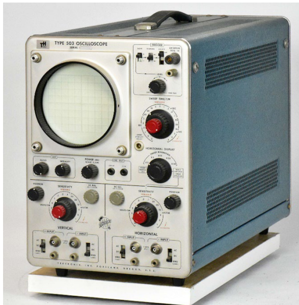
Figuur 2-40: De Tektronix 503 'Low Budget' oscilloscoop.
