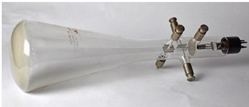
Figuur 2-4: Originele CRT van Manfred von Ardenne uit ca 1935; detail: de anode en het afbuigstelsel.
