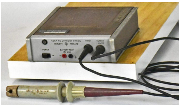
Figuur 4-8: De HP 456A: Stroomprobe met bijbehorende versterker.
