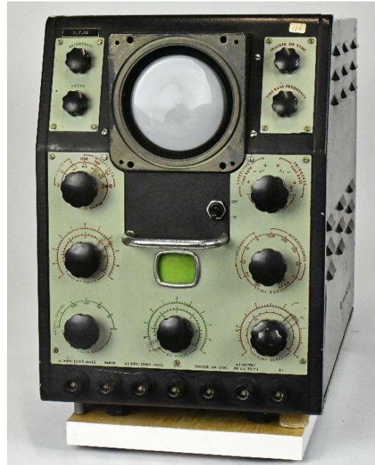
Figuur 2-13: Dubbelstraals oscilloscoop Cossor 1035.
