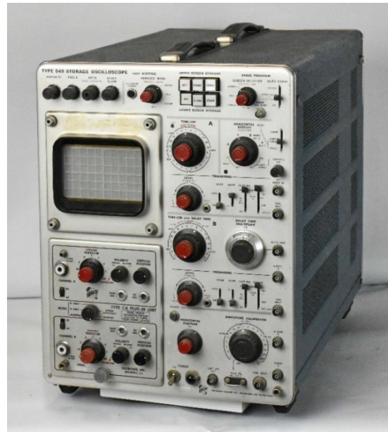
Figuur 2-51: Tektronix 549 'storage oscilloscope' (geheugenoscilloscoop).
