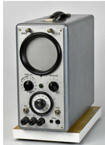
Figuur 2-30: AEG 015 oscilloscoop voor stroom – en spanningsmetingen in energiesystemen.
