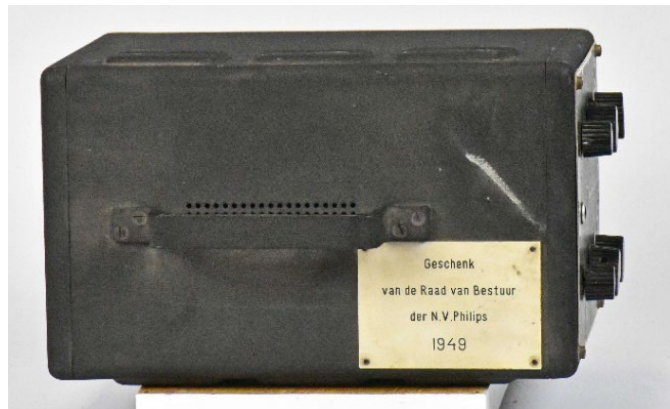
Figuur 4-1: De elektronenschakelaar Philips GM 4196, een geschenk van Philips aan de TH Delft a (links): vooraanzicht b (rechts): zijaanzicht
