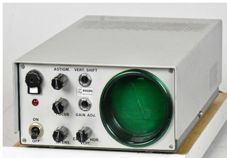
Figuur 2-81: De Philips EL84: Golfvormmonitor voor TV-kamera's.
