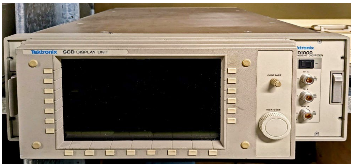
Figuur 2-90: de Tektronix SCD 1000 "transient waveform Recorder".
