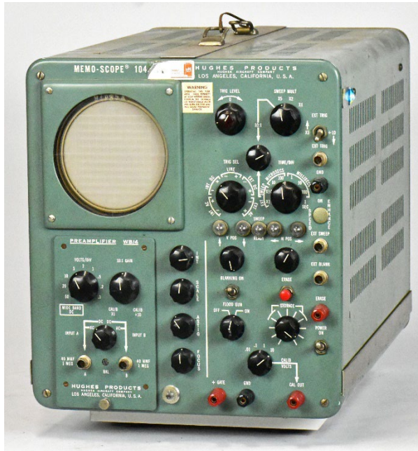
Figuur 2-25: De Hughes 104: een van de eerste geheugenoscilloscopen: 1957.
