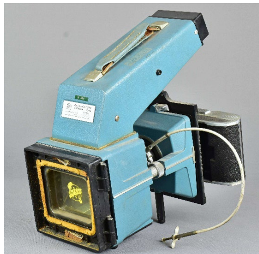
Figuur 4-12: De Tektronix C-12 camera met tussenstuk voor beeldschermfotografie.
