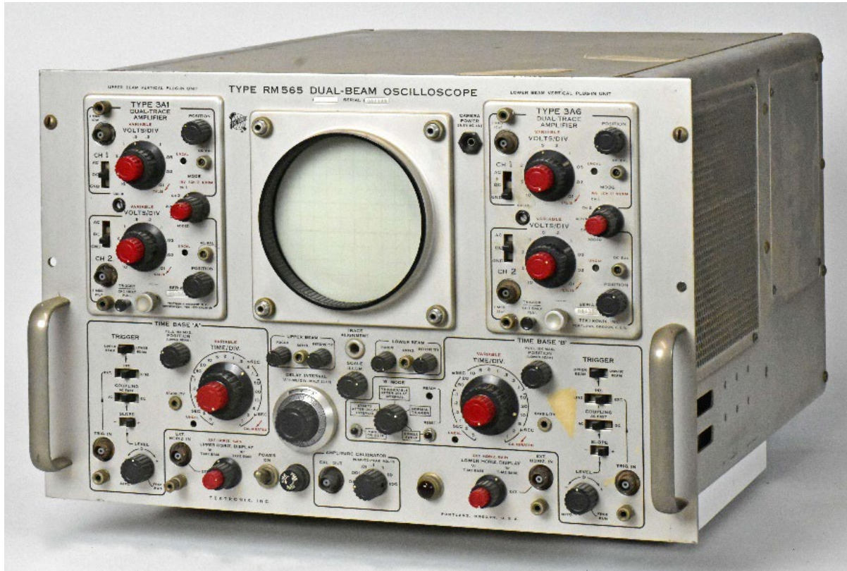
Figuur 2-46: De Tektronix dubbelstraals 'rackmount' RM565.
