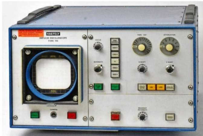
Figuur 2-86: De Haefely 711 "Impulse Oscilloscope".
