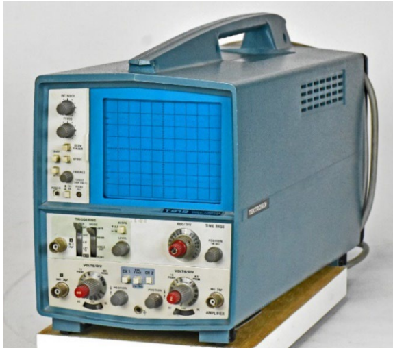
Figuur 2-73: De Tektronix T912 draagbare storage oscilloscoop.
