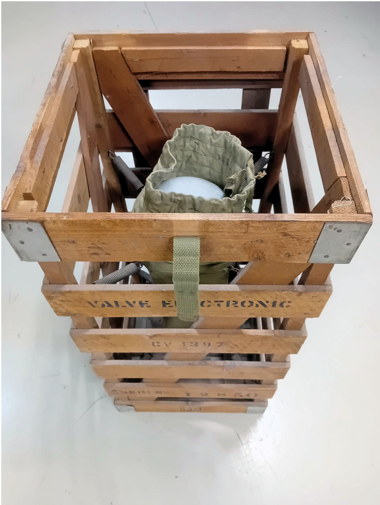
Kathodestraalbuizen zijn kwetsbare objecten: daarom werden ze voor transport vaak verend in een kist of krat opgehangen.
