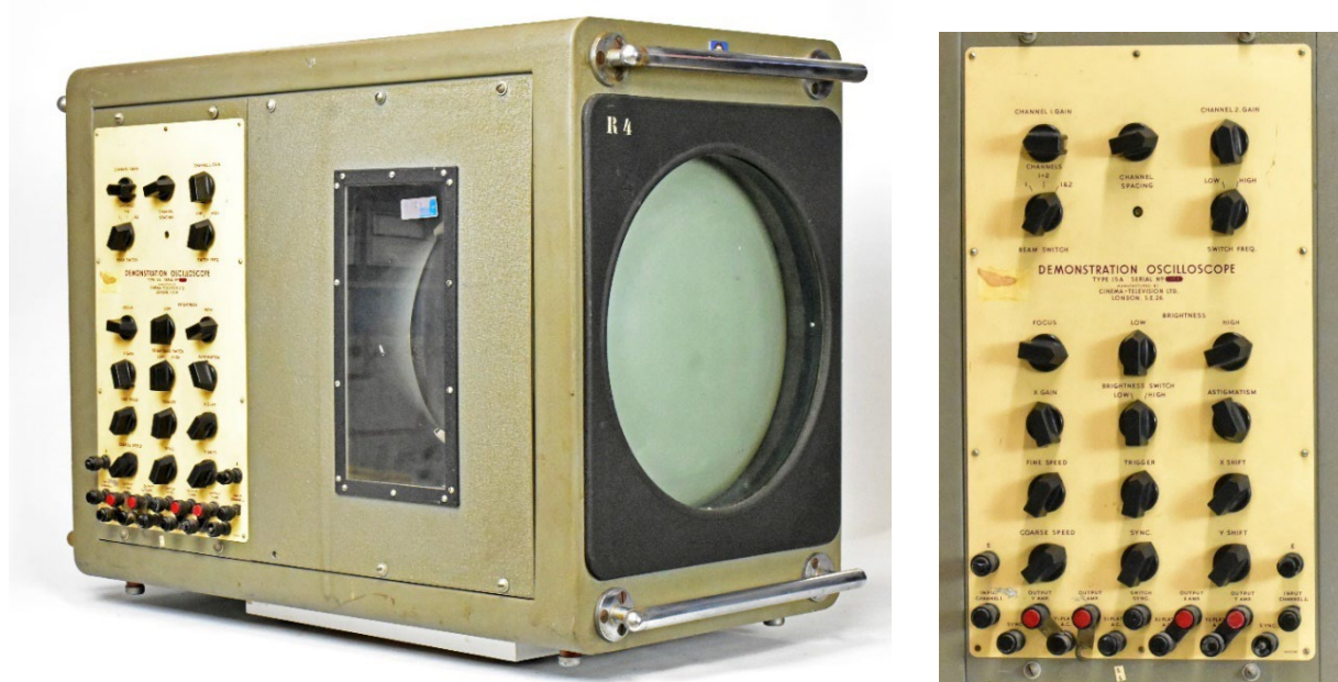
Figuur 2-83: De Cintel Type 15A grootbeeld oscilloscoop links: het gehele apparaat, rechts: het bedieningspaneel.
