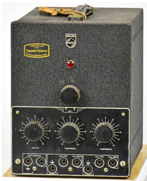
Figuur 4-1: De elektronenschakelaar Philips GM 4196, een geschenk van Philips aan de TH Delft a (links): vooraanzicht b (rechts): zijaanzicht
