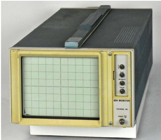
Figuur 2-79: Tektronix 604, X-Y monitor.
