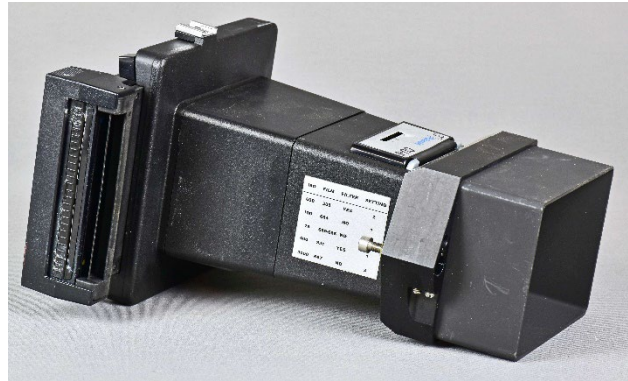
(a) Figuur 4-11: Twee exemplaren van de Polaroid CU-5 camera met tussenstuk voor beeldschermfotografie. (b)
