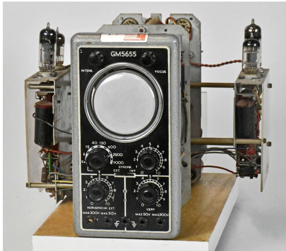
Figuur 2-18: opengewerkte Philips GM5655 voor studiedoeleinden.
