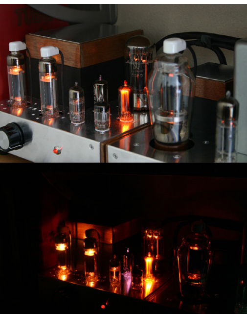
Figuur 5: Stereo 12W SE. Ontworpen voor maximaal vermogen en bass. Geweldige resultaten, desondanks in de wachtrij om gereviseerd te worden vanwege thermische problemen.
