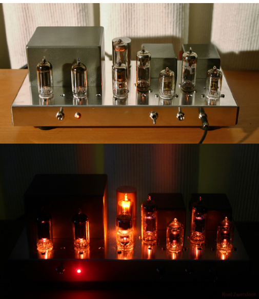
Figuur 3: Stereo 3W SE. Gebouwd om klein en goedkoop te zijn, heeft deze kleine amp toch verrassend veel 'punch' en is hij zeer stabiel.
