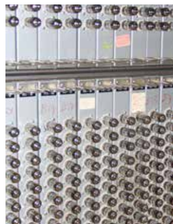
Afmetingen van de PASCAL: 2,70 m hoog, 2 m breed en 0,55 m diep. Het totale elektriciteitsverbruik bedroeg ca. 10 KW.
