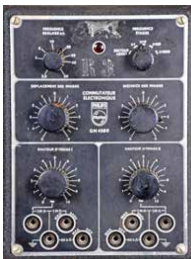
Figuur 4: Elektronenschakelaar: voorzetapparaat om 2 signalen op een éénstraals oscilloscoop weer te geven..
