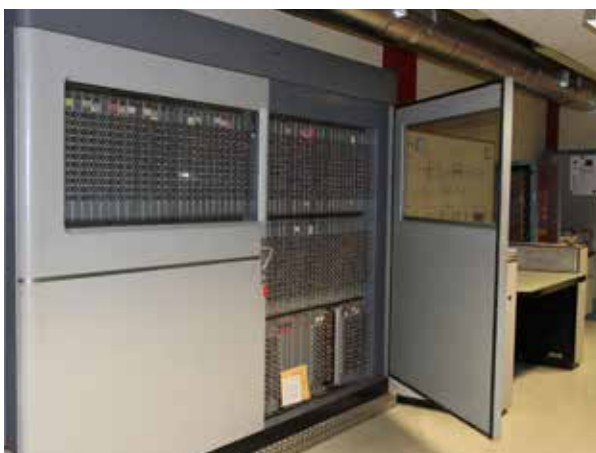
Afmetingen van de PASCAL: 2,70 m hoog, 2 m breed en 0,55 m diep. Het totale elektriciteitsverbruik bedroeg ca. 10 KW.
