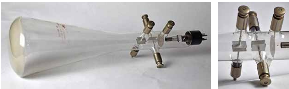
Figuur 1: Kathodestraalbuis uit het lab. van Manfred von Ardenne (ca 1940); detail: elektrodenconfiguratie.
