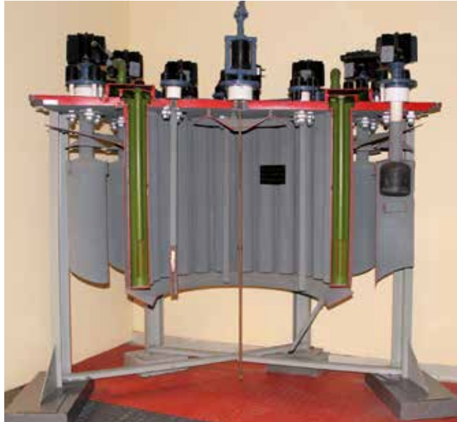
Opengewerkte kwikdampgelijkrichter, (190 x 185 cm).
