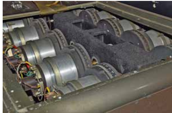
Figuur 2: X-Y resolvers en tandwielbak. Foto: Kees Pronk.
