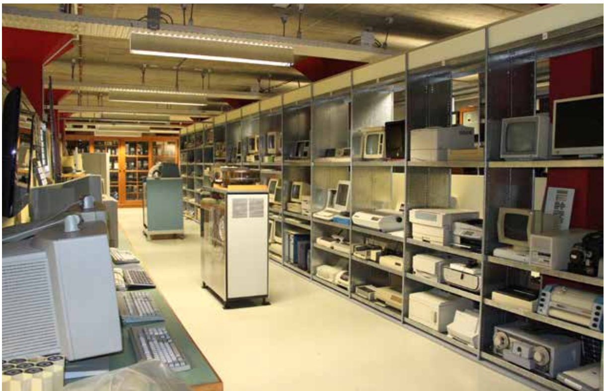
Computerruimte. In het middenpad zien we een grote harddisk, de 50 cycle power module FERRANTI (Burroughs USA) en daar achter een magnetisch schijfgeheugen jukebox, ca 1960.
