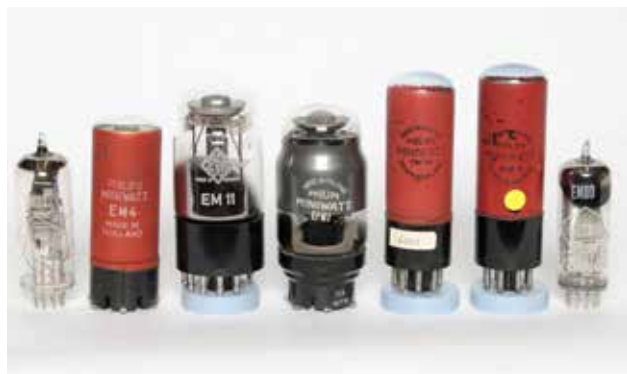
Buizen met verschillende contact-aansluitingen (buisvoeten).
